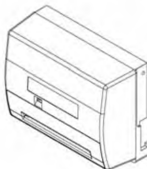
Лицевая панель с защитой от монет для валидаторов, устанавливаемых кассетой вверх
